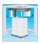
Máquinas totalmente automáticas com sistema de anel, para funcionamento autónomo ou integradas em linhas de embalamento novas ou existentes
