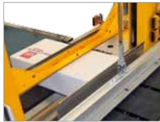
Batentes para o posicionamento correcto de embalagens/maços soltos
